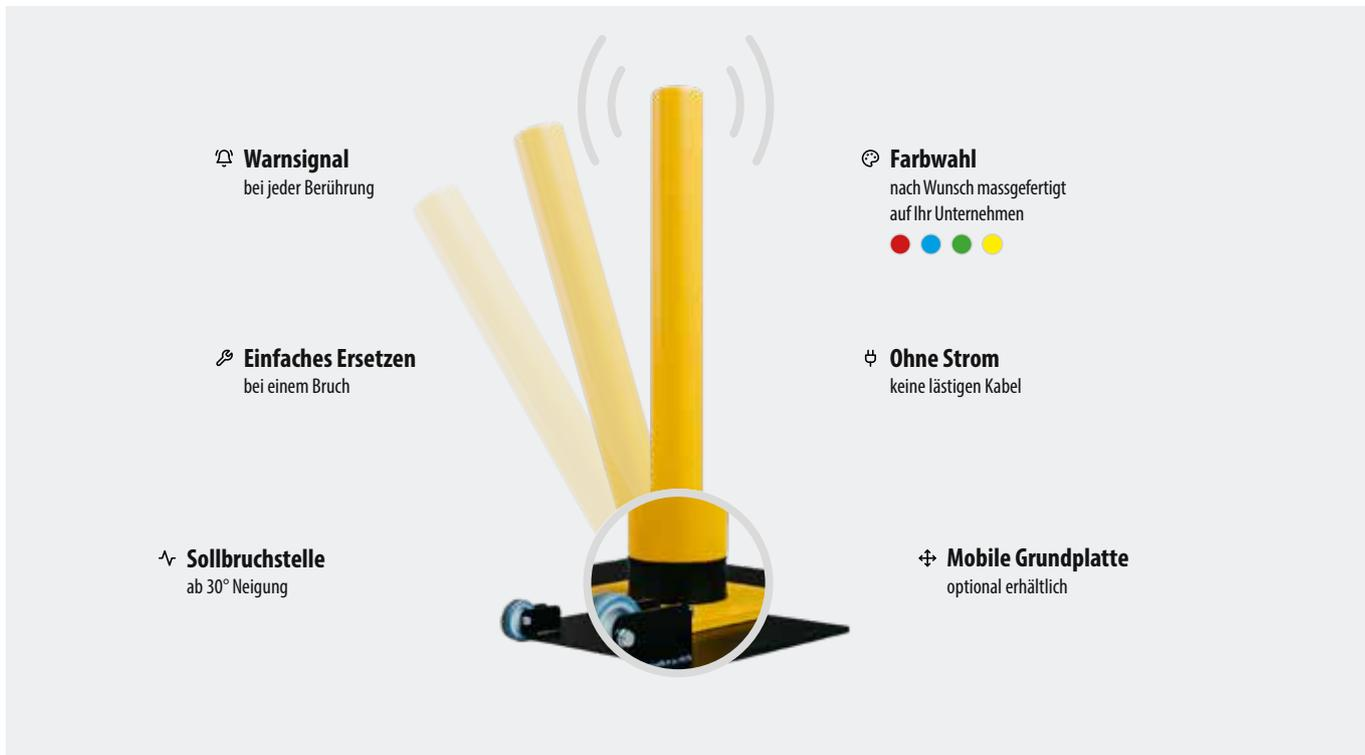
Der BellProtect ist ein patentiertes System mit einem integrierten Warnsignal, das beim Berühren ausgelöst wird. Durch die spezifisch konstruierte 4,5mm-Wandstärke und dem auswechselbaren Hartgummi Gelenk ist der BellProtect sowohl robust, biegsam als auch reparaturfreundlich, sollte doch einmal ein schwerer Schlag erfolgen.
