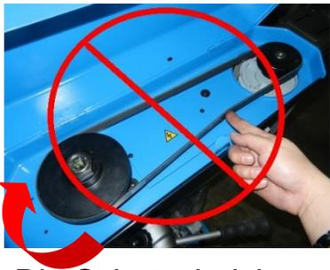
3. Die Schutzeinrichtung muss in der richtigen Betriebsposition angeordnet sein. Sie wird mit einem Mikroschalter gesteuert.
