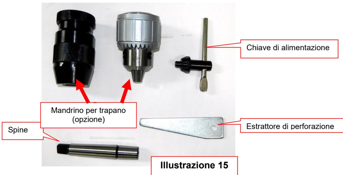
2. Pulire accuratamente con benzina leggera il mandrino, il perno e le prese del mandrino e asciugare tutte le superfici prima del montaggio. Seguire tutte le istruzioni di sicurezza riportate sul contenitore della benzina leggera. Se le superfici di accoppiamento non vengono pulite, la sede conica può allentarsi durante il funzionamento, con conseguente distacco e condizioni di pericolo. (Figura 16.17.18)
