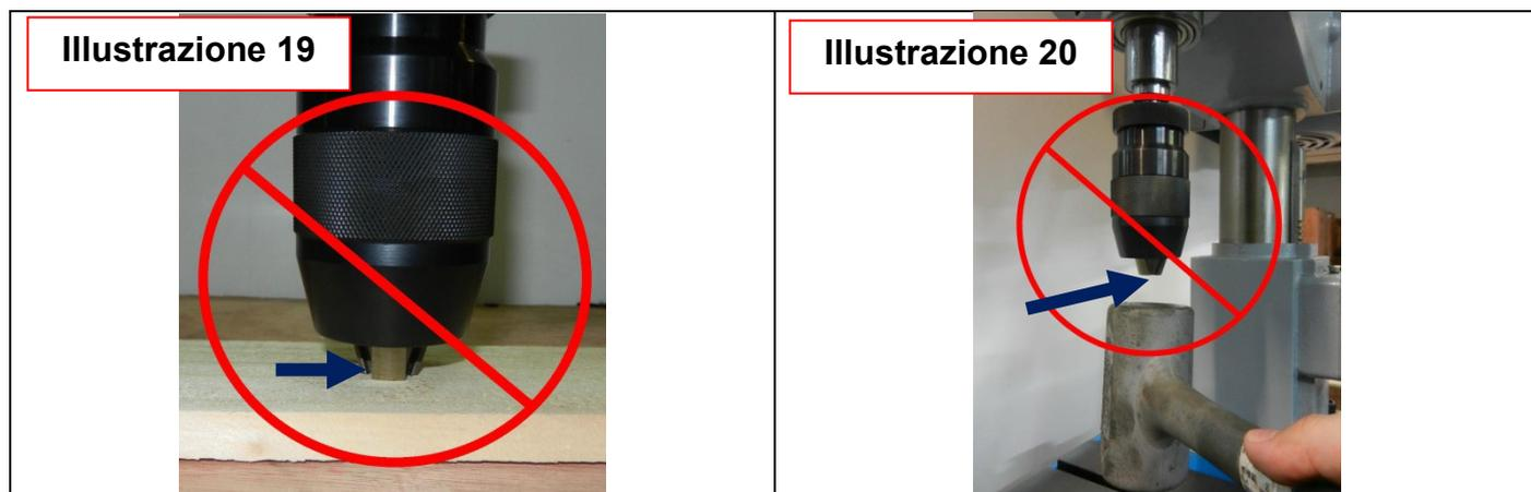
4. Posizionare il mandrino del trapano a faccia in giù su un banco di lavoro. Il mandrino ha un bordo corto e uno lungo smussato. Inserire il cono corto nella presa sul retro del mandrino del trapano e battere con un martello di gomma o di legno come mostrato in (Figura 21). Se il mandrino del trapano non si adatta saldamente all'albero, ripetere le fasi 1 e 2.
