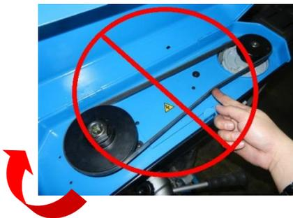
5. Le dispositif de protection doit être placé dans la bonne position de fonctionnement Il est commandé par un microrupteur.
