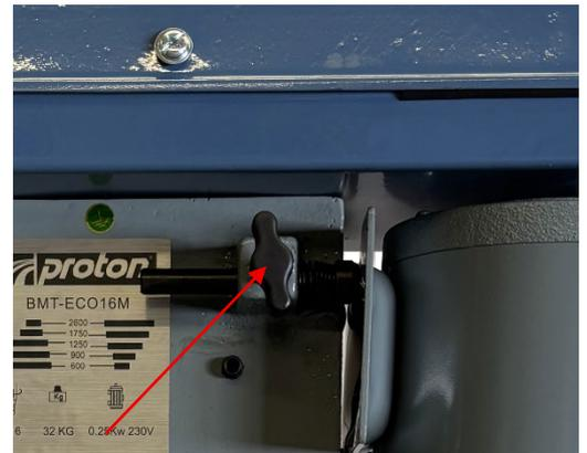
Beide Sechskantschrauben lösen, damit der Motor gedreht werden kann.
