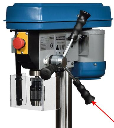
Bohrtisch auf einer Höhe fixieren, dass das Bohrfutter unter den Kegeldorn der Aufnahme gestellt werden kann. Mit einer Drehung am Drehgriff montieren Sie das Bohrfutter.
