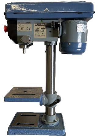
Die Schraube beim Bohrkopfdeckel lösen und wie auf der nebenstehenden Abbildung, mit dem schwarzen Knopf aussen, wieder befestigen.
