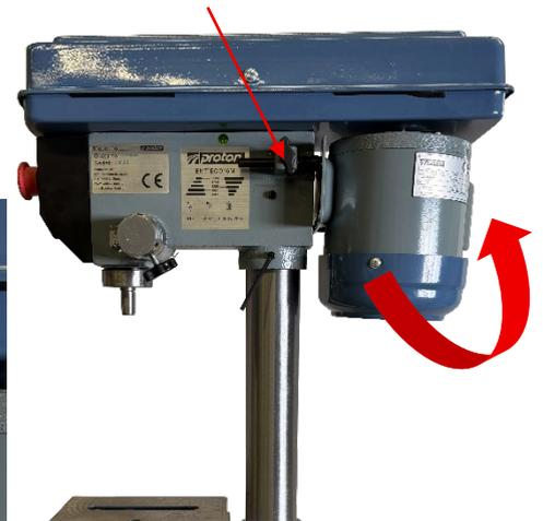
Si la courroie trapézoïdale peut être déplacée de  $\frac{1}{4}$  de tour, la tension optimale a été atteinte. Sinon, répéter l'étape précédente pour donner plus ou moins de tension à la courroie trapézoïdale.
