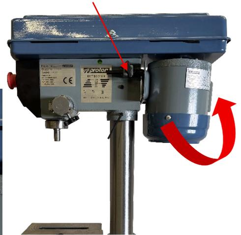
Wenn sich der Keilriemen um  $\frac{1}{4}$ -Drehung bewegen lässt, wurde die optimale Spannung erreicht. Ansonsten den vorherigen Schritt wiederholen, um mehr oder weniger Spannung auf den Keilriemen zu geben.
