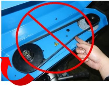
3. Die Schutzeinrichtung muss in der richtigen Betriebsposition angeordnet sein. Sie wird mit einem Mikroschalter gesteuert. **(Abbildung 12)**
