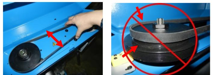
Um die richtige Riemenspannung zu erzielen, üben Sie einen Druck von 10 lbs oder einen Handdruck auf den Riemen aus.
