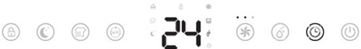
En fonctionnement, appuyez sur la touche de la minuterie pour sélectionner l'heure préférée 00-24-00 pour l'arrêt automatique.
