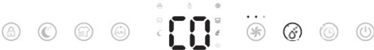
Appuyez sur la touche Manuel pour sélectionner le taux d'humidité préféré dans l'ordre CO-30%-35%-40%-45%-50%-55%- 60%-65%-70%-75%-80%-CO. CO indique la déshumidification en continu indépendamment de l'humidité ambiante.
