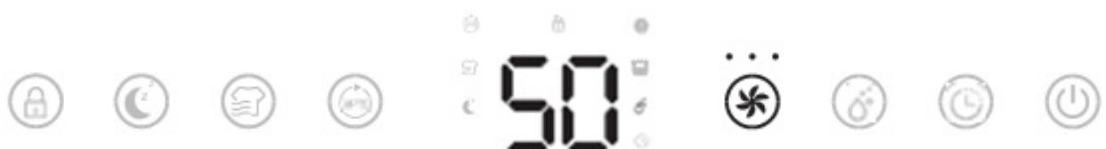
Appuyez sur la touche de vitesse du ventilateur pour sélectionner votre réglage préféré de la vitesse du ventilateur entre faible, moyen et élevé en vue de répondre aux différents besoins d'utilisation.
