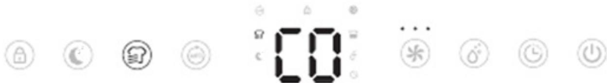
Appuyez sur la touche de séchage de linge pour activer la fonction de lavage séchage, l'appareil fonctionne en déshumidification continue avec la vitesse élevée du ventilateur pendant 6 heures, puis s'éteint automatiquement.
