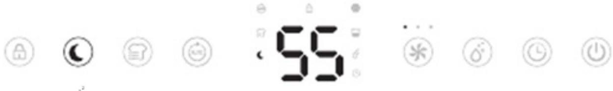
Drücken Sie die Sleep-Taste, um die Sleep-Funktion zu aktivieren, das Gerät läuft mit einer eingestellten Luftfeuchtigkeit von 55 % und der niedrigsten Lüfterdrehzahl. Alle Blinker und das dreifarbiges Licht erlöschen 5 Sekunden nach Abschluss der Einstellung. Berühren Sie eine beliebige Taste, um das Licht zu aktivieren und das Gerät wie gewohnt zu betreiben.
