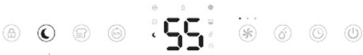
Appuyez sur la touche de veille pour activer la fonction de veille, l'appareil fonctionne alors avec une réglage d'humidité fixé à 55 % et la basse vitesse du ventilateur. Tous les témoins ainsi que le voyant lumineux tricolore s'éteignent 5 secondes après avoir terminé le réglage. Appuyez sur une touche quelconque pour allumer le témoin et utiliser l'appareil de la manière habituelle.
