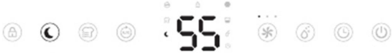
Premere il tasto sleep per attivare la funzione Sleep, l'unità funziona con un'impostazione di umidità designata del 55% e con bassa velocità della ventola. Tutte le spie e la luce a tre colori si spengono 5 secondi dopo il completamento dell'impostazione. Toccare un pulsante qualsiasi per attivare la luce e per operare normalmente.
