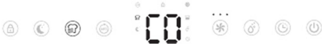
Premere il tasto asciugabiancheria per attivare la funzione asciugabiancheria; l'unità funziona in deumidificazione continua con alta velocità della ventola per 6 ore, quindi si spegne automaticamente.
