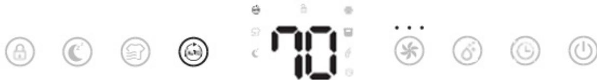
Appuyez sur la touche Auto pour activer le mode de déshumidification automatique, l'appareil fonctionne alors automatiquement en fonction de l'humidité ambiante détectée.
