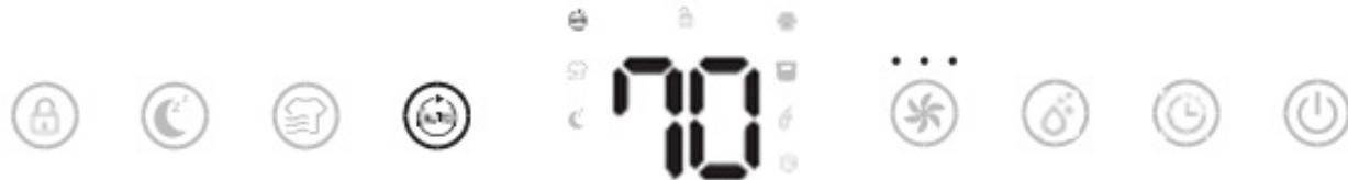
Premere il pulsante auto per attivare la modalità di deumidificazione automatica; l'unità si avvia automaticamente secondo l'umidità ambientale rilevata di seguito.
