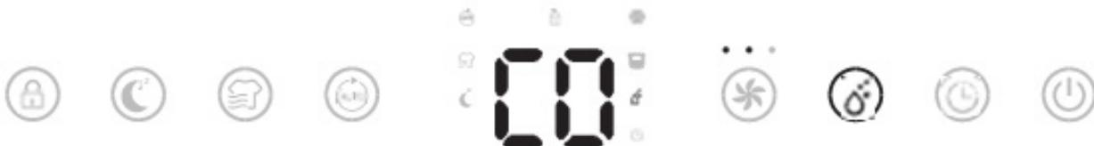
Betätigen Sie die Manual Taste, um die gewünschte Luftfeuchtigkeit auszuwählen von CO - 30% - 35% - 40% - 45% - 50% - 55% - 60% - 65% - 70% - 75% - 80% - CO. CO bedeutet kontinuierliches Entfeuchten, unabhängig von der Feuchtigkeit in der Umgebung.
