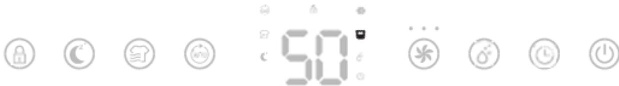
Das Gerät wechselt in den Standby-Modus, wenn der Wasserbehälter voll ist oder der Wasserbehälter nicht ordnungsgemäss installiert ist. Nach der Entleerung des Tanks oder der ordnungsgemässen Installation des Wassertanks wechselt das Gerät in den vorherigen Modus.
