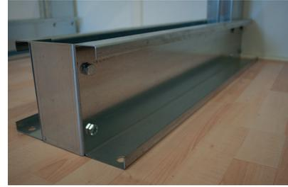
Fussteile links/rechts mit Sechskantschrauben M 10 x 130, Unterlagscheiben und Muttern M 10 an Ständer befestigen.
