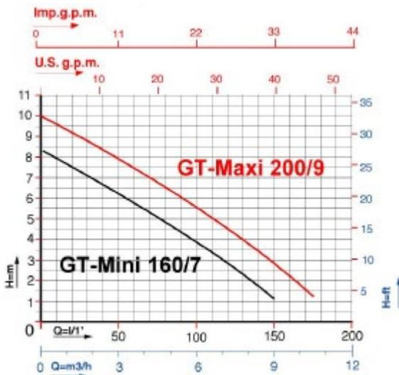
Die Messung der maximalen Leistungsdaten erfolgt bei geradem, direktem Ausgang. Der Winkeladapter kann die Leistung reduzieren.
