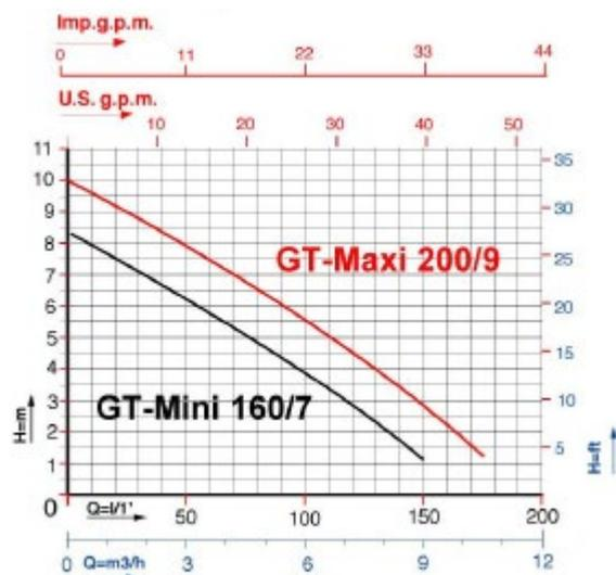
I dati di potenza massima sono misurati con un'uscita diretta e diritta. L'adattatore angolare può ridurre la potenza.
