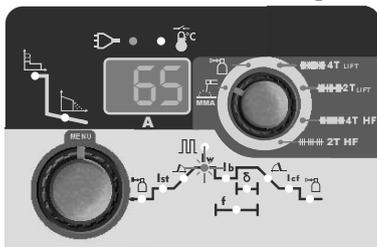
Appuyer de nouveau sur le bouton de régulation des paramètres de soudage (6) pour valider le courant configuré. Le générateur confirme automatiquement la configuration au bout de 3 secondes.
